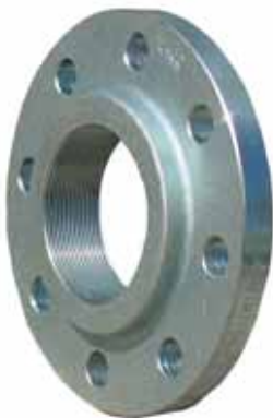
DRAADFLENZEN STAAL DIN 2566 /EN 1092-1(13) ST37 VERZINKT - 16 BAR -
